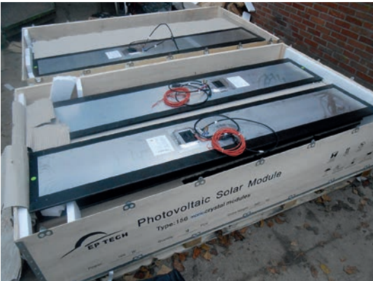
Achterzijde van de PV-modules, die inclusief bekabeling worden geleverd. De modules zijn zes pannen breed.
